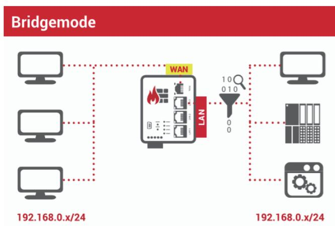
在Bridge模式下，工業防火牆集線器可以輕鬆安裝到現有的網路中，無須更改任何網路範圍，並保護其端口之間的數據交換，過濾WAN和LAN之間的數據封包。他透明化的整合、融入，所以不需要分配IP地址。
