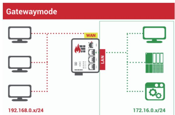
在Gateway模式下，WAN和LAN接口將各別獲得不同網段 IP地址，因而對原先網路設定進行分區段。透過此設置，可以運用網路和轉發功能，將數據流量發送到另一網段。同時間，WAN和LAN之間的封包數據，也進行過濾管理。
